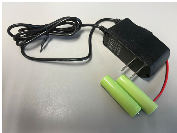
Fig. 4.8 ダミー電池による電源供給
