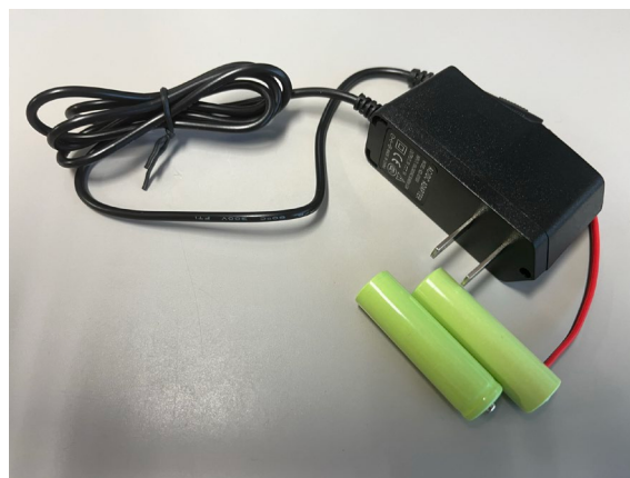
Fig. 4.8 ダミー電池による電源供給
